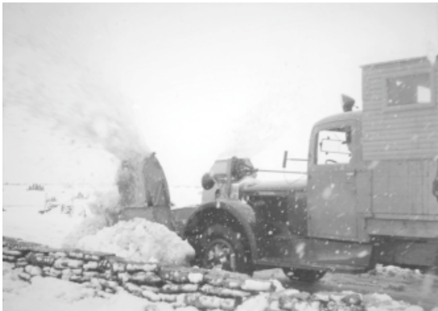
Veoauto Reo Harju maavalitsuse teedeosakonnas Boris Upine poolt konstrueeritud puhur-lumesahaga 1936. aastal.
